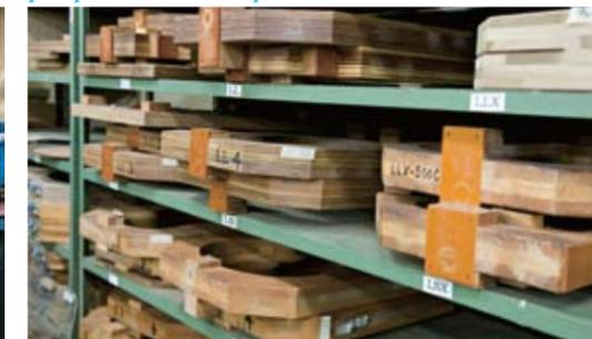
*Различные шаблоны для корпусов на фабрике.*
