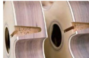
Корпус прокумерован, чтобы после окончания отделочных работ его можно было соединить с идеально подходящим грифом.
