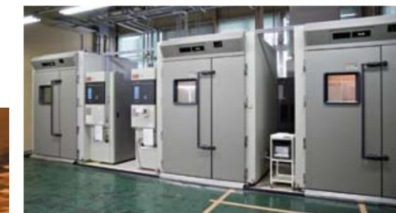
Испытательные камеры температуры и влажности, используемые для ускоренных испытаний воздействия на гитары внешних факторов.
