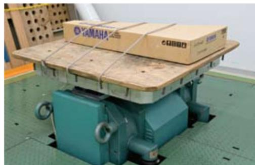
*Испытания на вибрационном столе имитируют тип вибрации, с которым может столкнуться продукция в ходе транспортировки.*
