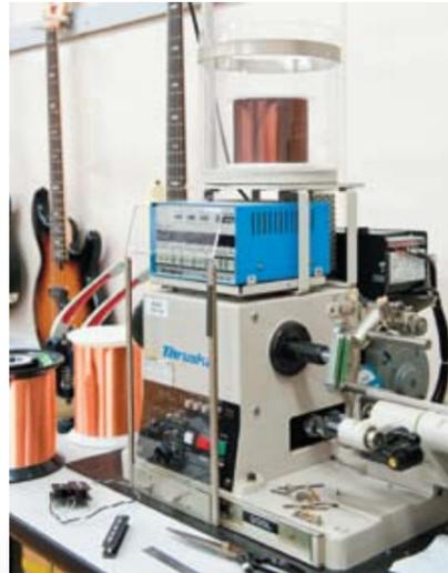
*Этот программируемый намоточный станок для звукоснимателей в исследовательском центре компании Yamaha используется для испытания различных сочетаний параметров катушечной обмотки.*
