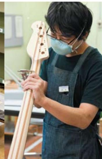
Контуры и размеры грифа тщательно проверяются на точность и однородность.
