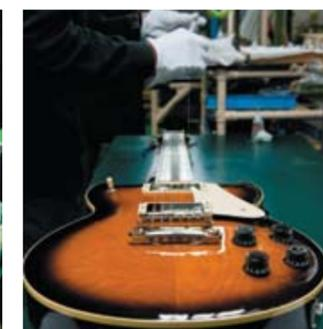
*Почти готово: установка струн на гитару серии SG. Установка бриджевого звукоснимателя в бас-гитару серии BB.*
