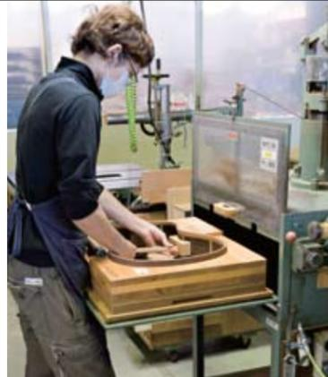
*Мастер загружает конструкцию корпуса в контурный шлифовальный станок.*
