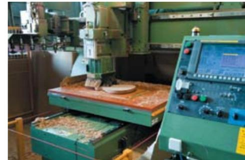
*Деки электрических гитар и бас-гитар с цельным корпусом изначально вырезаются и обрабатываются на фрезерных станках с компьютерным управлением.*
