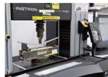
Анкерные стержни гитар проходят испытания под тоннами давления в сертифицированном Центре поддержки качества Yamaha.
