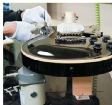
Электрическая гитара серии SG проходит заводскую обработку с помощью технологии искусственного "разыгрывания".
