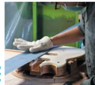
*Обработка контура деки на специальном ленточном шлифовальном станке.*
