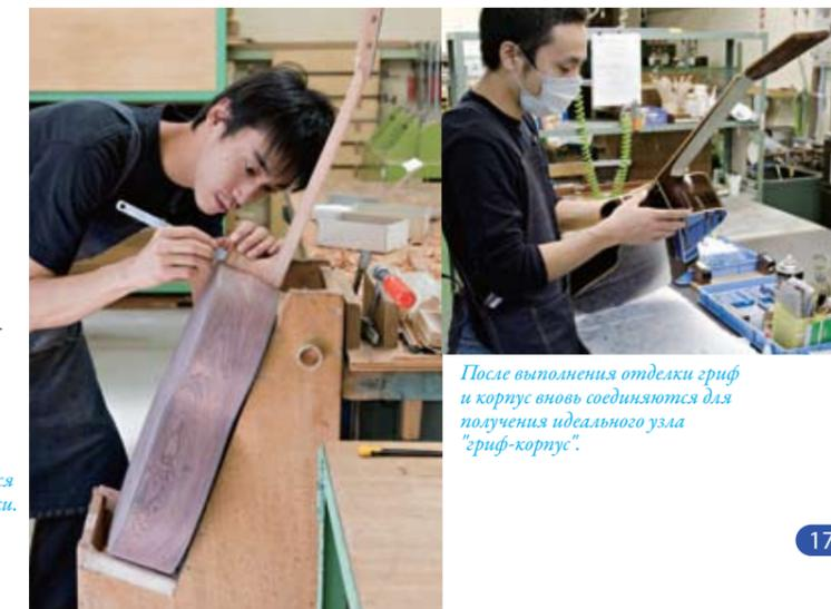
*После выполнения отделки гриф и корпус вновь соединяются для получения идеального узла "гриф-корпус".*
