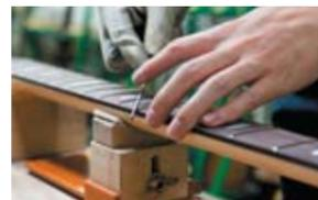
*Ни одна подробность при окончательной доводке ладов не пропускается: здесь лады скругляются для удобства игры.*
