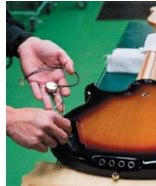
*Установка электропроводки и контроллеров в бас-гитару серии BB.*
