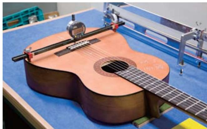
*По мере того, как испытываемые гитары переводятся из одной экстремальной среды в другую, они тщательно измеряются на коробление и деформацию.*
