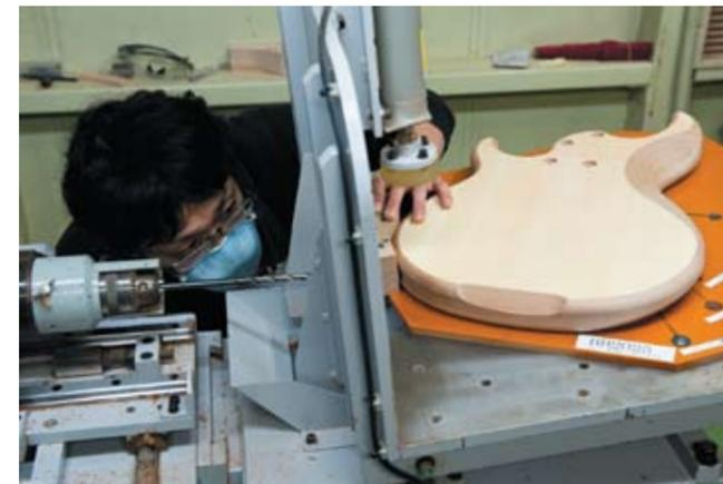
*Станок, обладающий высокоточной повторяемостью, разработан специально для просверливания деки гитары*
